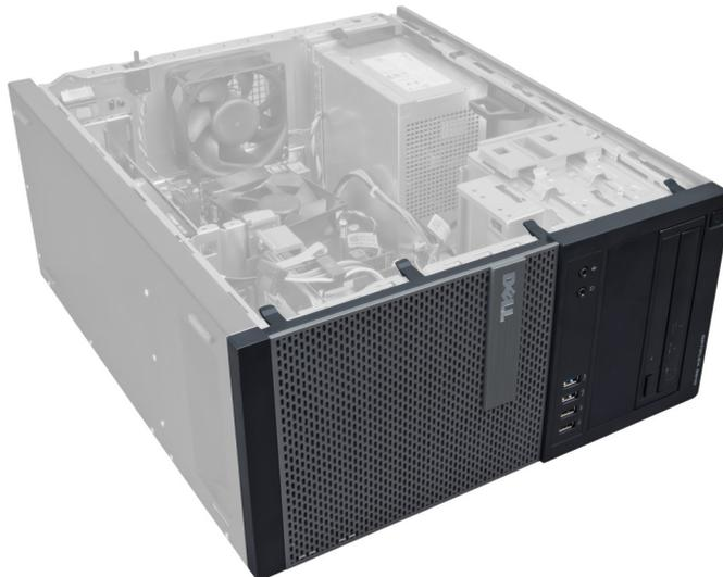
3. Afaste delicadamente os cliques de fixação do painel frontal do chassi localizados na borda lateral do painel frontal.
