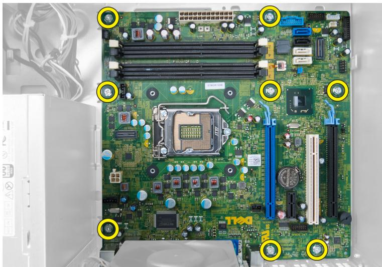
5. Deslize a placa de sistema em direção à frente do computador.
