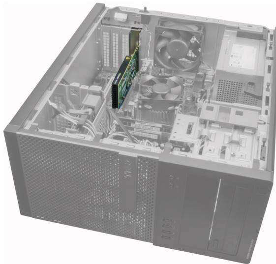
3. Pressione a trava de retenção da placa no lado interno e puxe a trava para fora no outro lado.
