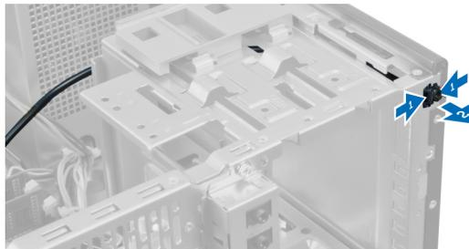
6. Deslize a chave liga/desliga junto com seu cabo para fora pela frente do computador.
