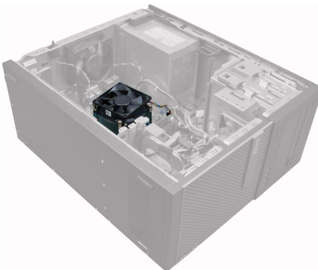
3. Pressione o clipe plástico para liberar e desconectar o cabo do dissipador de calor da placa de sistema.
