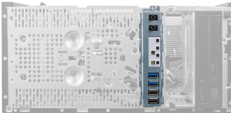
4. Desconecte o cabo do painel de E/S e o cabo FlyWire da placa de sistema.
