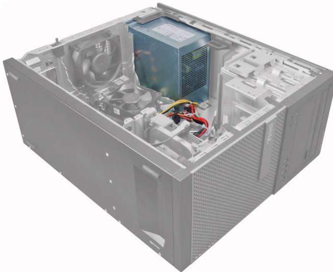
3. Solte e desconecte os cabos de alimentação da(s) unidade(s) óptica(s).
