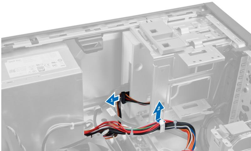
4. Desconecte o cabo de alimentação do(s) disco(s) rígido(s) e libere-o do clipe. Desconecte o cabo de 24 pinos da placa de sistema.
