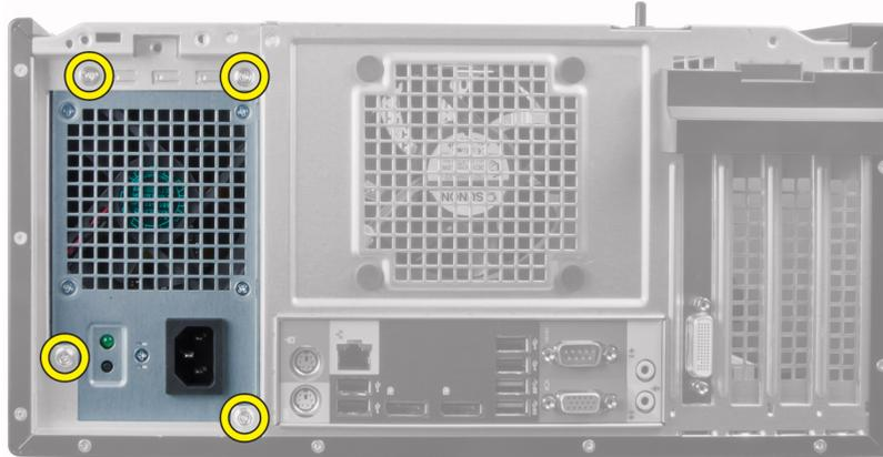
7. Faça pressão sobre a aba de liberação azul ao lado da fonte de alimentação e deslize a fonte de alimentação em direção à frente do computador.
